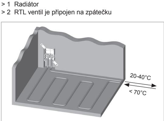
Před prováděním omítky doporučujeme krabici RTL ventili uzavřít a rovněž sejmout hlavici, aby nedošlo k poškození ventili nebo hlavice. Po dokončení omítky hlavici namontujeme zpět.
