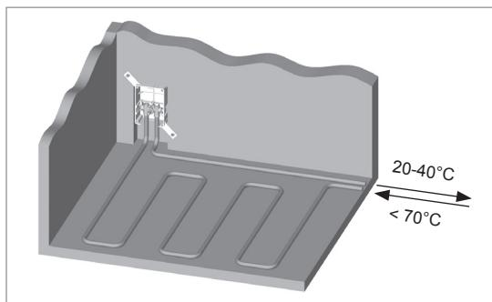
Voordat er met het stucwerk wordt begonnen, moet de RTL-kop worden verwijderd en moet de kunststof afscherming op de RTL Box worden geplaatst. Nadat het stucwerk is aangebracht, moet het werk worden afgerond door de RTL-kop aan te sluiten, de afscherming te plaatsen, en als laatste de kunststofring.
