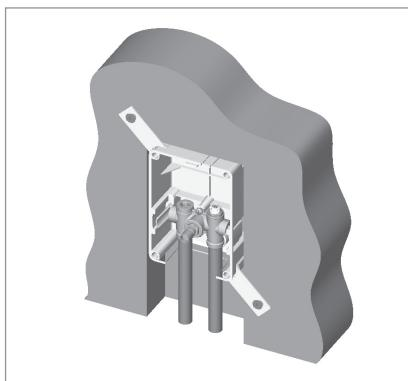
Następnie, należy umieścić skrzynkę w przygotowanym otworześciennym o wymiarach 180 x 230 mm. Skrzynka mocowana jest do ściany za pomocą przykręcanych wcześniej uchwytów montażowych. Przy użyciu śrub regulacyjnych ustawić skrzynkę tak, aby wystawała ona 1,5 cm poza płaszczyznę ściany, tak aby pozostawić miejsce na tynk. Opcjonalnie, przestrzeń powstałą między skrzynką a ścianą, można wypełnić pianką izolacyjną.
