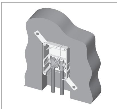
Dalším krokem je zabudování krabice do stěny do otvoru o rozměrech 180 x 230mm a hloubce +/- 63mm. Krabice je upevněna pomocí dříve namontovaných spon. Pomocí šroubů na sponách docíláme toho, aby krabice vystupovala zhruba 1,5 cm nad povrch, aby bylo možné udělat omítku. Volný prostor mezi otvorem ve zdi a krabicí je možné vyplnit isolací.
