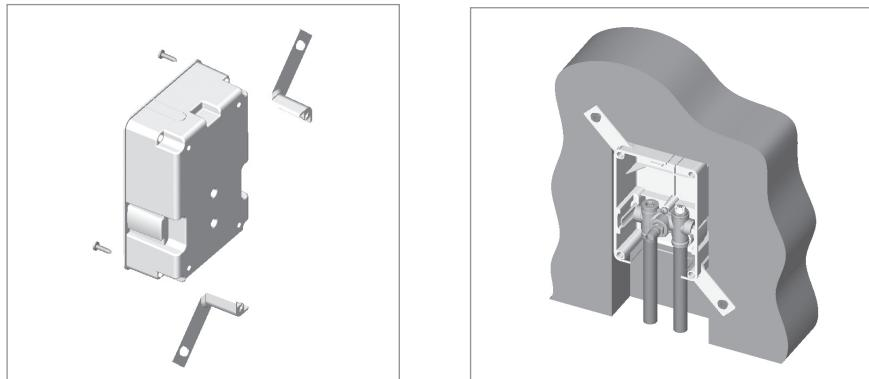
Daarna wordt de box in de vrij gemaakte ruimte in de muur van 180 x 230 mm en +/- 63 mm diep geplaatst. De box wordt aan de muur bevestigd met behulp van de twee beugels die diagonaal op de box zijn bevestigd. Met de verstelschroeven wordt de box geplaatst waarbij er een ruimte overblijft van ongeveer 1,5 cm voor de stucwerklaag die later wordt aangebracht. Als optie is het mogelijk om de overgebleven ruimten tussen de box- en de muurruimte te vullen met isolatieschuim.
