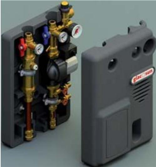
Kuglasti ventil sa integrisanim termometrom pokazuje temperaturu vode koja izlazi, dok termometar na drugom kuglastom ventilu pokazuje temperaturu vode koja ulazi u cirkulacionu grupu. Na svojoj zadnjoj strani, cirkulaciona grupa ima metalnu ploču koja omogućava jednostavnu instalaciju.
