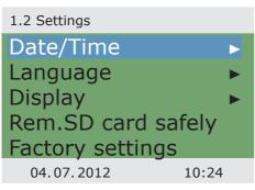
>SD-Karte sicher entfernen< muss vor Entnehmen der Micro-SD-Card angewählt werden.
